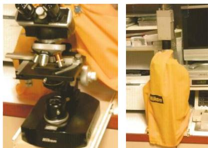
顕微鏡は、引き出し様にスライドできるテーブルに置かれ、検査する人の膝の上まで近寄せることができる。布で作ったカバーの特徴は、すその部分にチェーンを縫い込んで通しておく(風呂桶の水栓を継いでいるボールチェーンがよい)。カバーが顕微鏡のライトの筒等をスムーズにまたぎ安定する。
